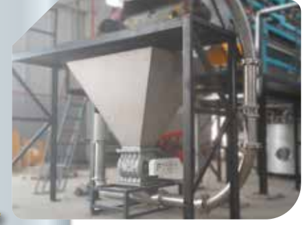
Yükleme haznesinde bulunan malzemenin siloya aktarılması Conveying the bulk solid from the hopper to the silo
