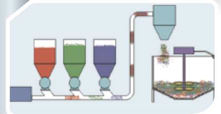
Silolarda bulunan farklı malzemelerin dozajlama ile mikserde karıştırılması Dosing different granular materials and filling a mixer or blender
