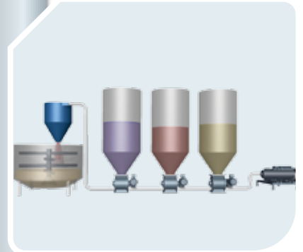
Silolarda bulunan farklı hammaddelerin dozajlanarak miksera aktarılması Dosing of different materials form silos to the mixer
