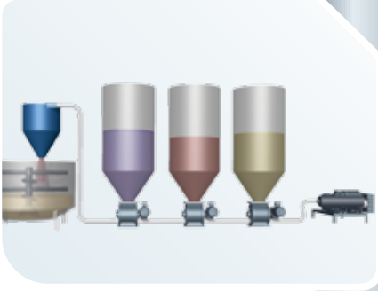
Silolarda bulunan farklı hammaddelerin dozajlanarak miksera aktarılması Dosing of different materials from silos to the mixer
