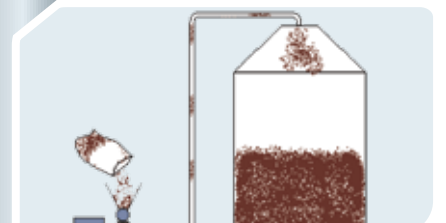
Çuvaldaki malzemenin siyola doldurulması Emptying the bag and loading silo
